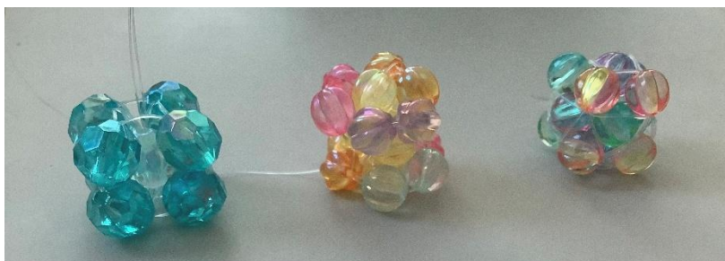
図3 手芸用ビーズで作った結晶格子モデル
